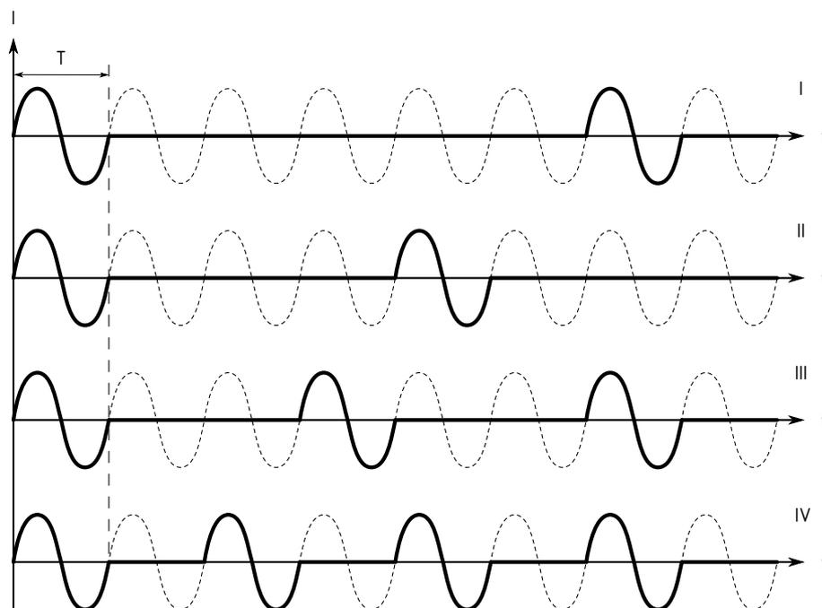
Рисунок 1.6 – Режим «Плавный пуск»
