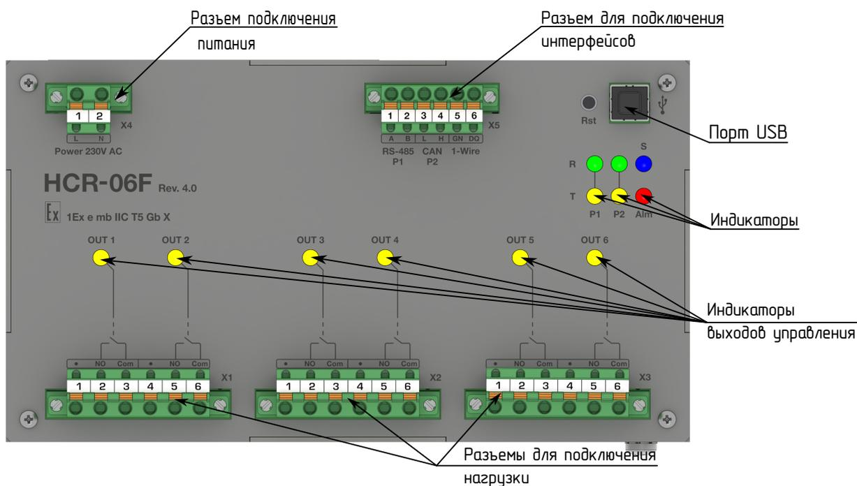
Рисунок 1.2 – Назначение основных элементов на лицевой панели
